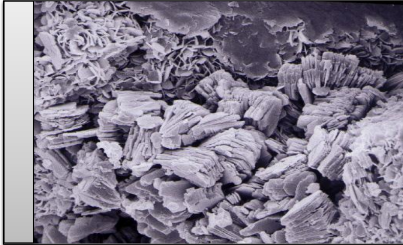
الشكل (9-1): صورة مجهرية لبنية صفائح الكاولينيت
